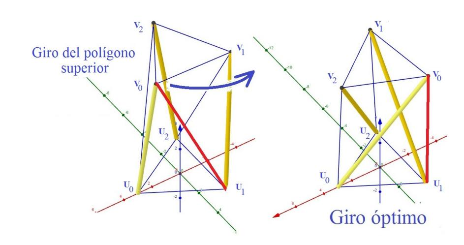
A medida que el triángulo superior gira, disminuye su altura y la longitud del cable rojo varia. Y llega un momento en que ésta longitud empieza a aumentar. El problema es determinar el valor de  $\theta$  de tal manera que ésta longitud es mínima.
